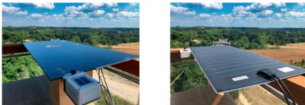
Sl. 6–49 CdTe (lijevo) i CIGS (desno) tehnologija
