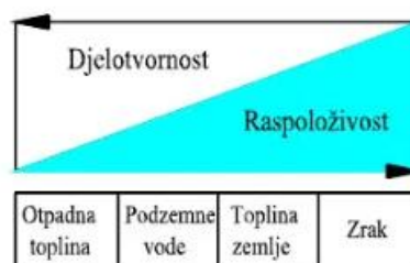
Sl. 6–40 Djelotvornost i raspoloživost toplinskih izvora za dizalicu topline
